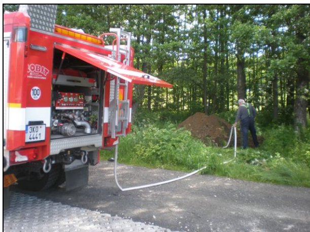
Nálev vody do sondy č. 2 a měření poklesu hladiny vody v sondě během vsakovací zkoušky
